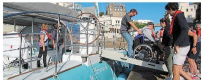
Une passerelle a été ajoutée au navire Ephata pour accueillir les personnes à mobilité réduite.
